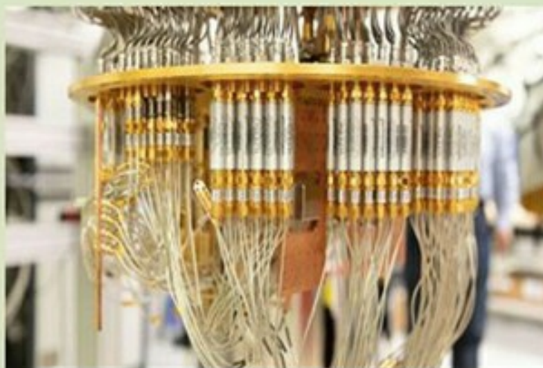
کامپیوتر کوانتومی گوگل ساختاری به شدت پیچیده دارد. هر کدام از کابل ها یا خطوطی که در اینجا می بینید وظیفه ارسال سیگنال های الکترومغناطیسی را بر عهده دارند که برای کنترل محاسبات و خوانش دیتای به دست آمده از کیوبیت ها به کار می روند.
